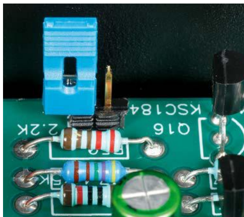
Per Jumper auf der Platine lässt sich die Grundverstärkung für besonders leise Quellgeräte um sechs Dezibel anheben.
