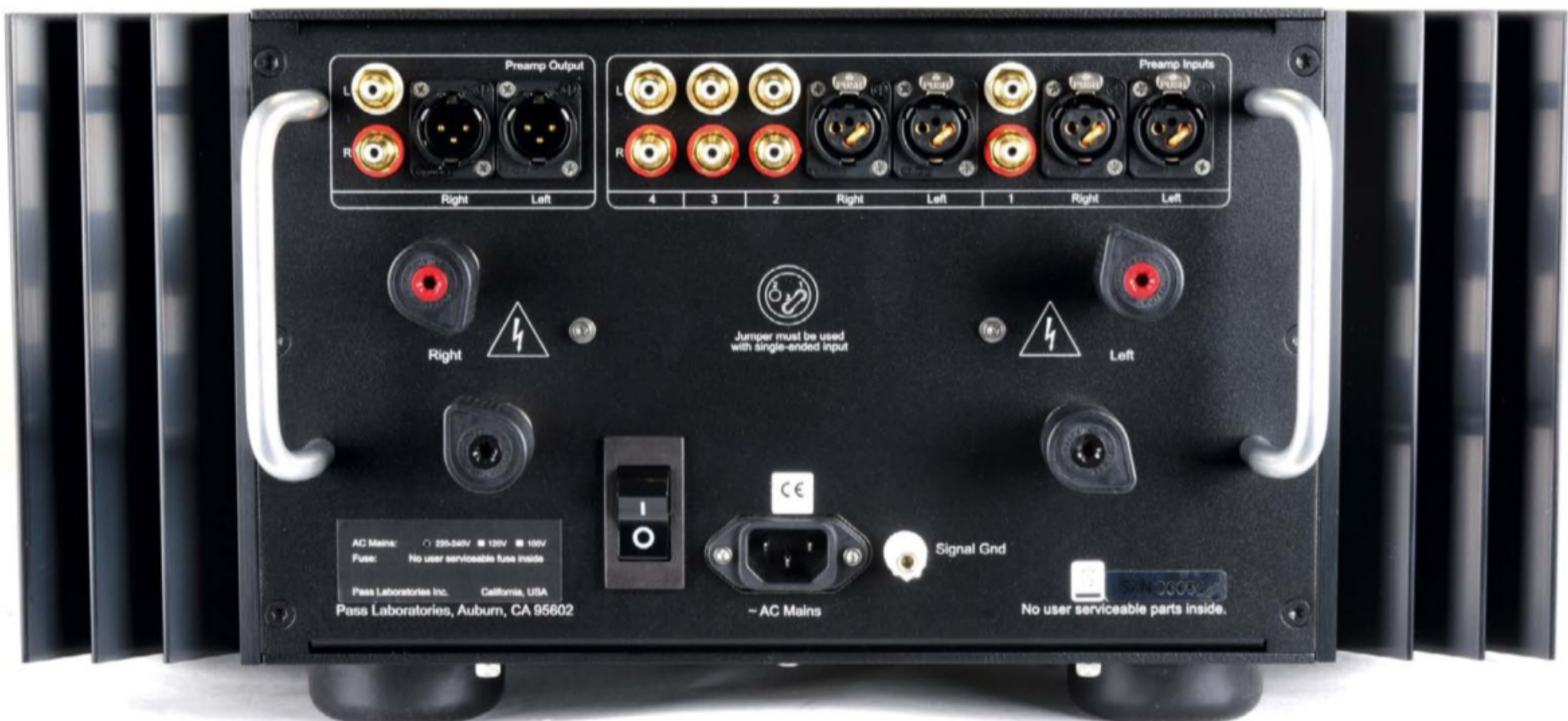
Unsymmetrische Signale werden intern symmetriert. Die Ausgänge mit Linepegel dienen zum Anschluss aktiver Subwoofer oder einer Endstufe. Praktisch: Die großen Lautsprecherklemmen akzeptieren auch Bananenstecker und natürlich die üblichen Gabel-Kabelschuhe.
