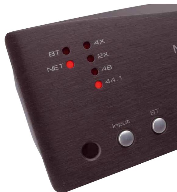
Einige LEDs geben Aufschluss über den gewählten Eingang und die genutzte Abtastrate
