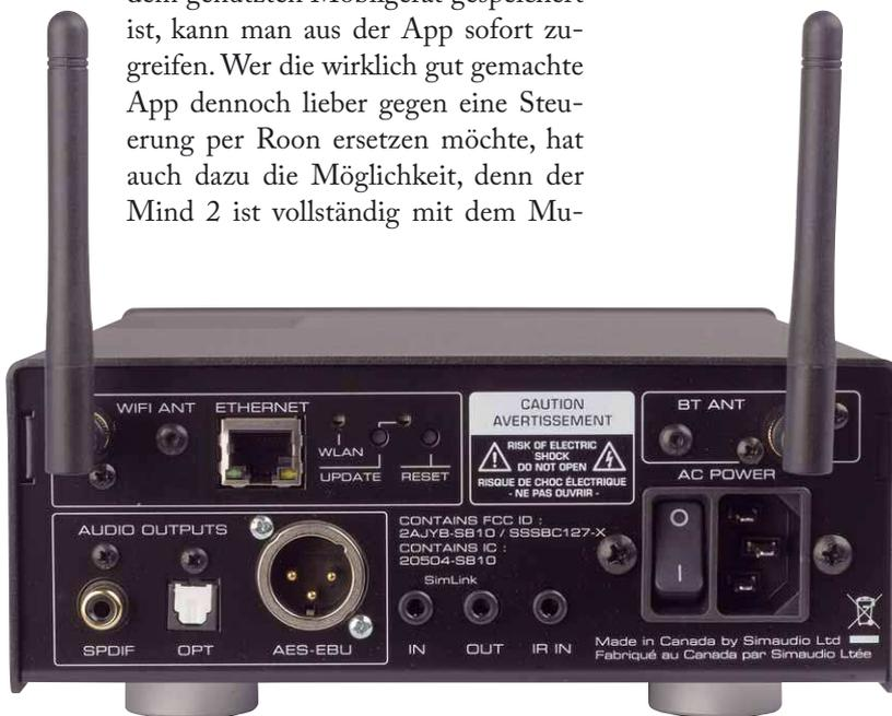
Mit unterschiedlichen S/PDIF-Ausgängen und einer guten Wireless-Unterstützung ist der Mind 2 gut ausgestattet
