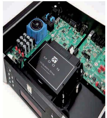
Die MM/MC-Phonoplatine ist hochwertig bestückt und kann angepasst werden (li.). Das hauseigene M-Quattro-Laufwerk des CD-Players ist mit einer Geldämpfung vor Vibrationen geschützt.
