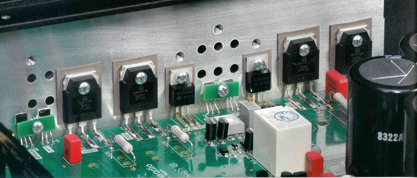
Oben: Das puristische, voll symmetrische Layout gewährleistet neben dem durchdachten Gehäusedesign und dem Einsatz bipolarer Transistor-Typen in allen Lebenslagen höchste thermische Sicherheit
