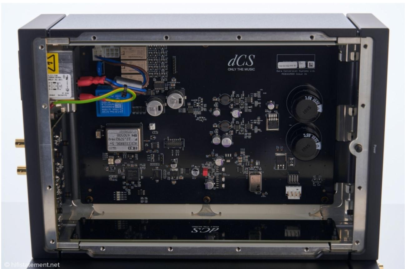
Die Clock mit dem spannungskontrollierten Oszillator für Signale mit einem Vielfachen von 48 Kilohertz oben links der Mitte und rechts der beheizte Quarzoszillator des englischen Herstellers HCD Research für Signale mit Bezug zu 44,1 Kilohertz
