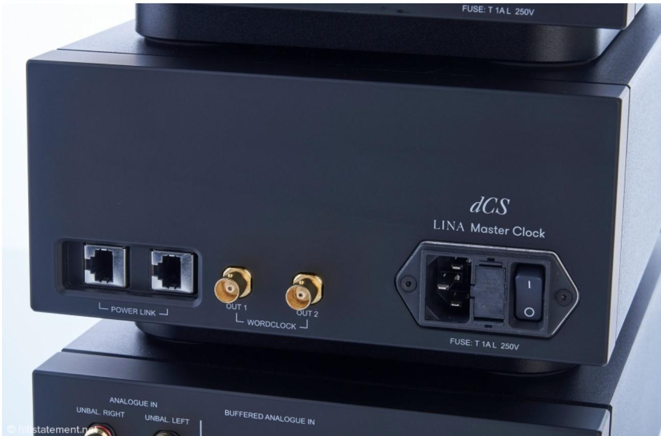
*Das Anschlussfeld der Clock mit den Buchsen für die Ferneinschaltung und den BNC-Anschlüssen für die beiden Taktfrequenzen*
