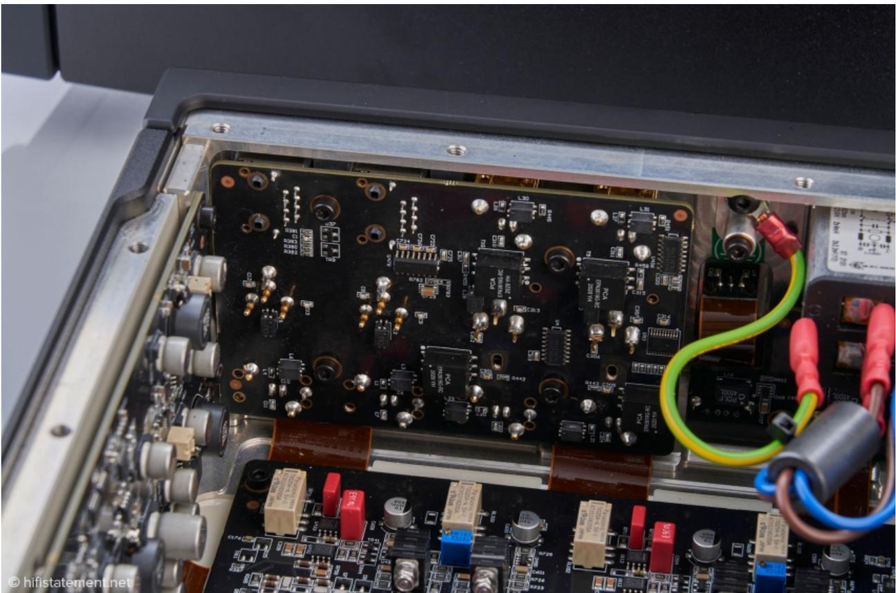
*Wandler, Streamer und Upsampler: Die Packungsdichte im Network DAC ist hoch. Diese Platine sitzt direkt hinter den Ein- und Ausgängen*
