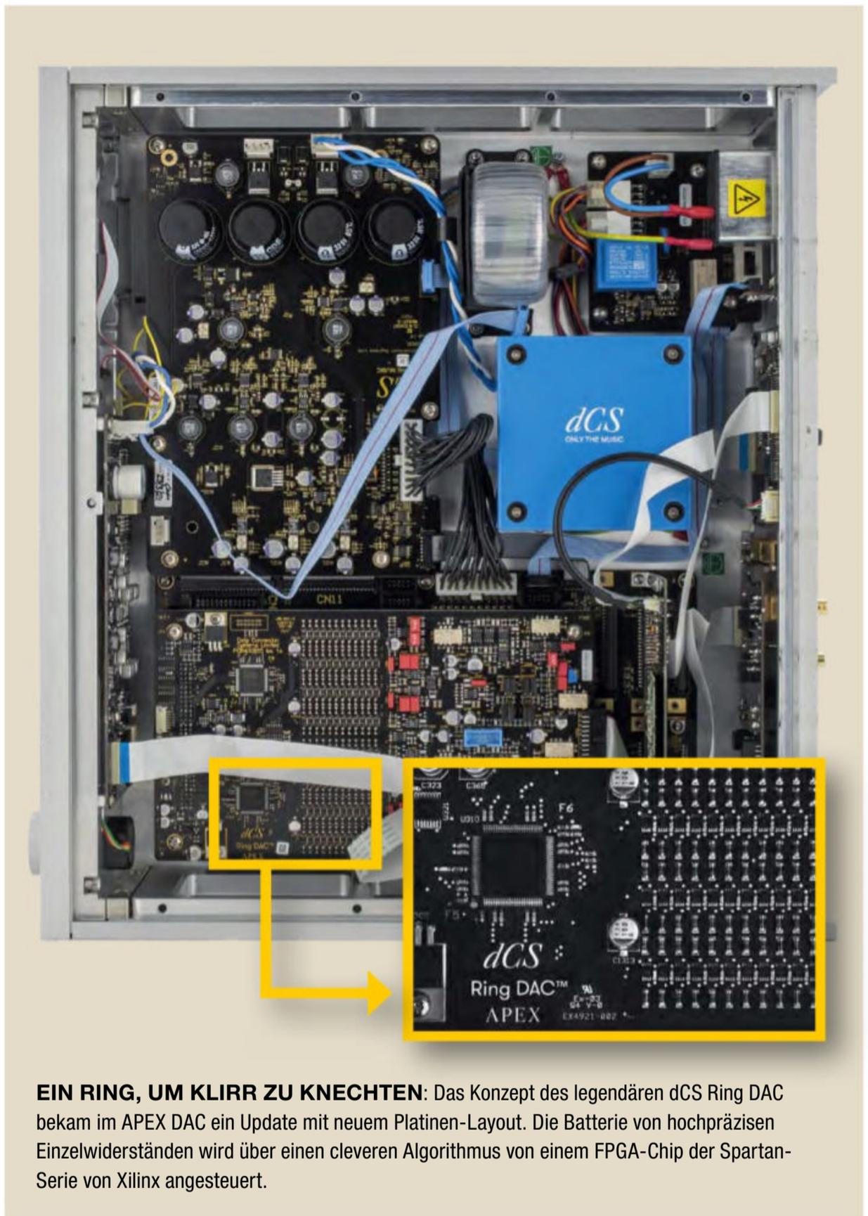
**EIN RING, UM KLIRR ZU KNECHTEN:** Das Konzept des legendären dCS Ring DAC bekam im APEX DAC ein Update mit neuem Platinen-Layout. Die Batterie von hochpräzisen Einzelwiderständen wird über einen cleveren Algorithmus von einem FPGA-Chip der Spartan-Serie von Xilinx angesteuert.
