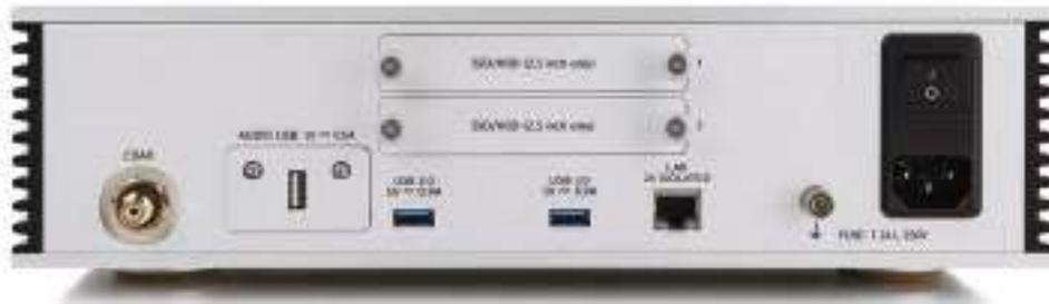
**Auf der Rückseite finden sich neben den beiden Schächten für Speichermodule die beiden Digitalausgänge (Koax/USB) sowie zwei USB-Schnittstellen für externe Festplatten respektive Sticks und die LAN-Buchse.**
