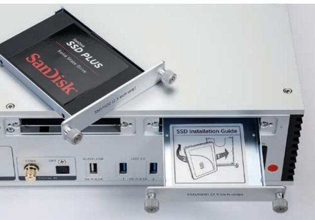
Zwei fest mit der Rückwand verschraubbare Metallhalter nehmen HDD- oder SSD-Speicher mit bis zu insgesamt 16 Terabyte Kapazität auf.
