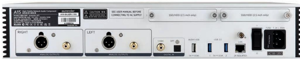
Die Rückseite bietet neben den mit Cinch- und XLR-Buchsen versehenen Analogausgängen zwei digitale Inputs, drei USB-Schnittstellen, einen LAN-Anschluss sowie zwei Schächte für Festplatten.
