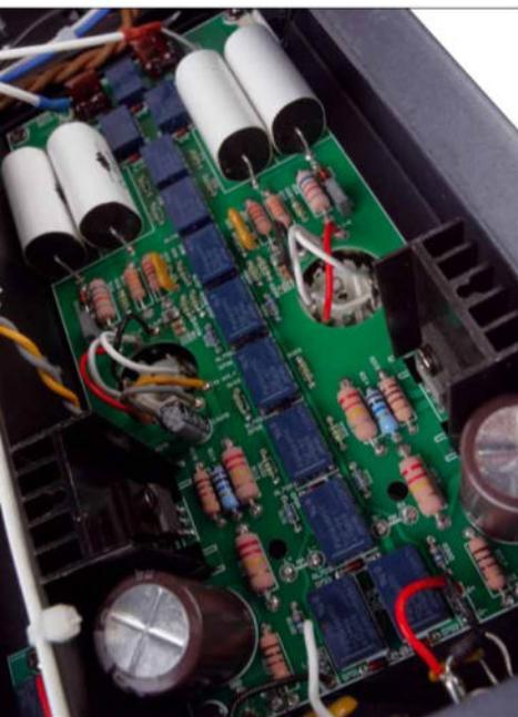
Fürs Umschalten der Anschlussparameter sind jede Menge Relais zuständig
