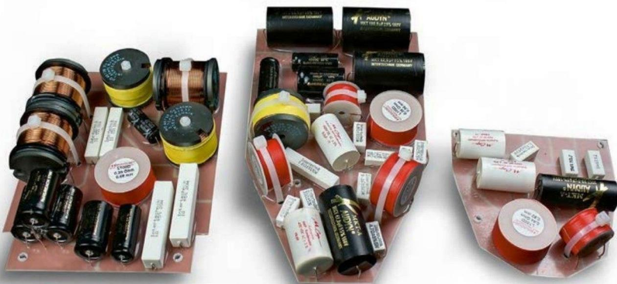
Für jeden Frequenzbereich hat die Gauder eine eigene, höchstwertig mit Mundorf-Bauteilen bestückte Weiche.
