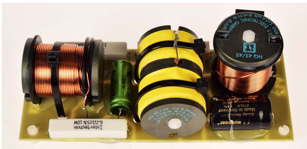
Nur hochwertige Zutaten finden sich auf der Frequenzweiche, hier etwa von Mundorf und InterTechnik.
