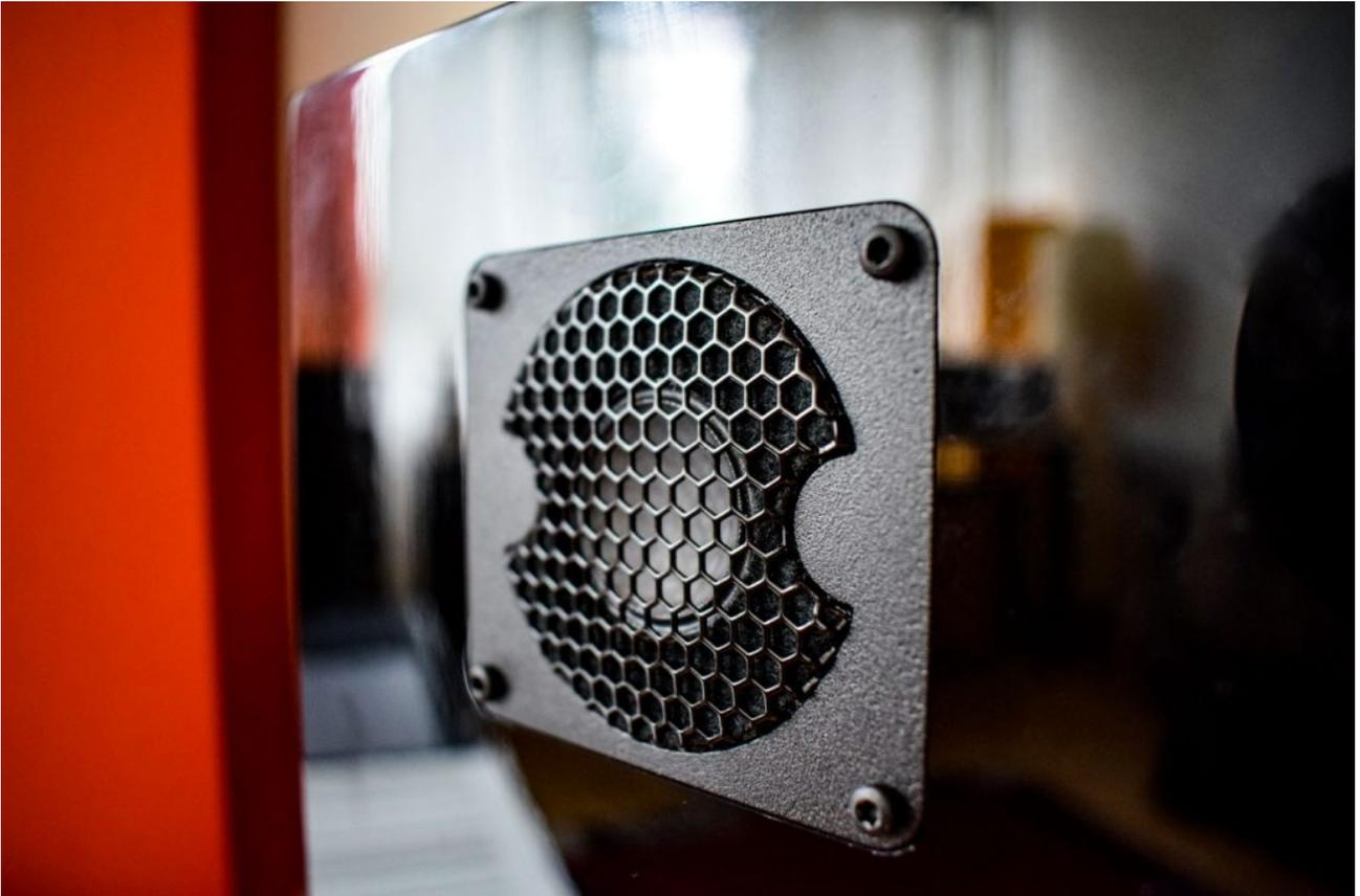
*Hightech hinter Gittern: der Accuton Hochtöner mit 25 mm Invers-Kalotte aus Keramik, leichter Titan-Schwingspule und extrem starken FeNdB-Magneten. Der Magnet hat eine Polkernbohrung, so dass die Membran-Reflexionen vom Polkern minimiert werden (Foto: H. Biermann)*
