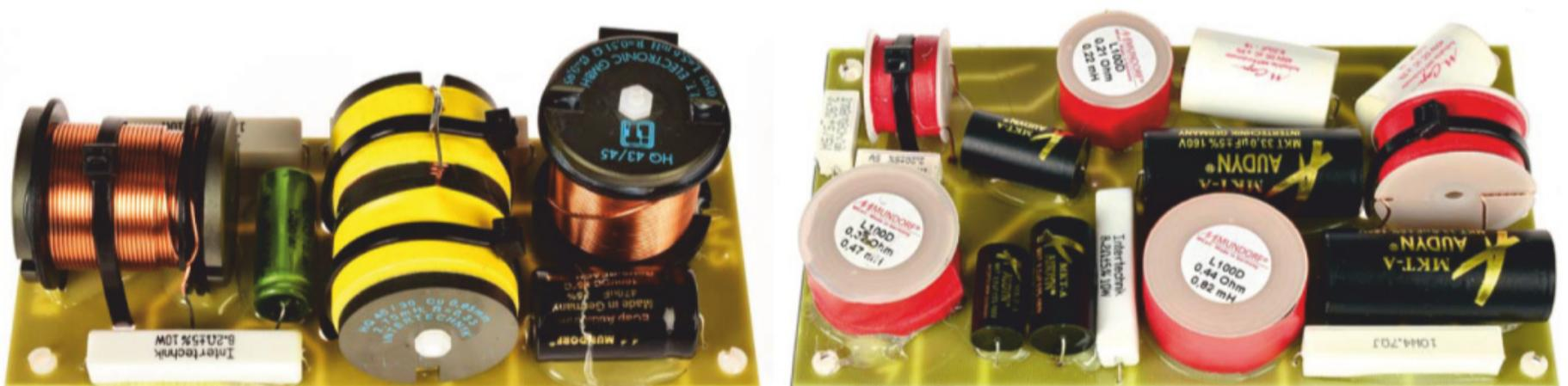
**NUR VOM FEINSTEN:** Das Erfolgsrezept der Arcona-Serie ist für den Besitzer unsichtbar und liegt im Inneren der Box verborgen. Die beiden Platinen der Frequenzweiche sind ausschließlich mit hochwertigen Komponenten von Mundorf und Intertechnik bestückt.
