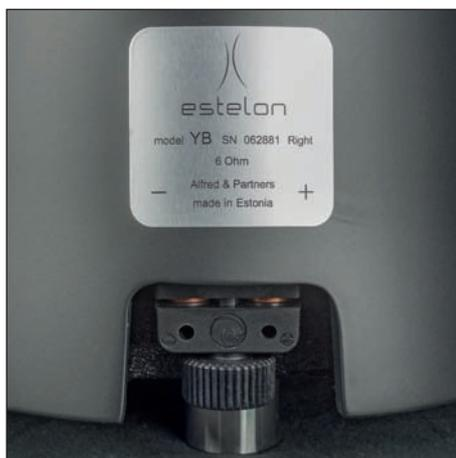
Das Terminal ist „amerikanisch“ ausgeführt – eine Klemmschraube fixiert beide Bananenstecker des Kabels
