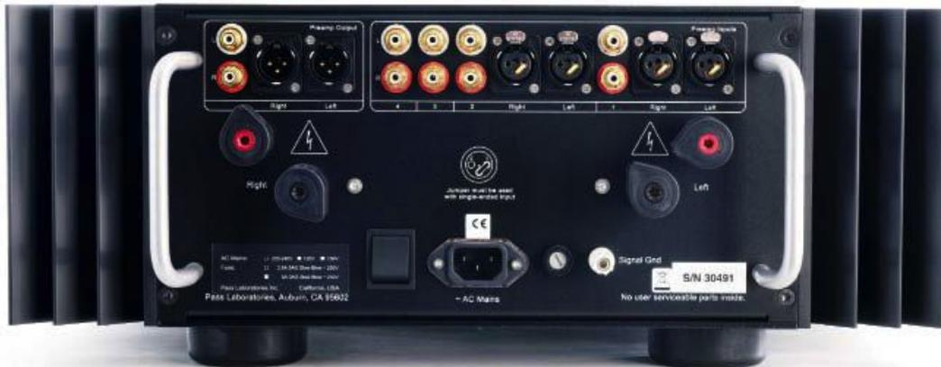
Das 42-Kilo-Ungetüm besitzt praxisorientiert zur Erzielung des besten Geräuschspannungsabstands sogar eine Erdungsbuchse. Schließt man eine Phonostufe an, so sollte deren Erdungskontakt mit dem INT-60 verbunden werden, die Erdung(en) vom Plattenspieler gehören ebenfalls an den Vollverstärker.
