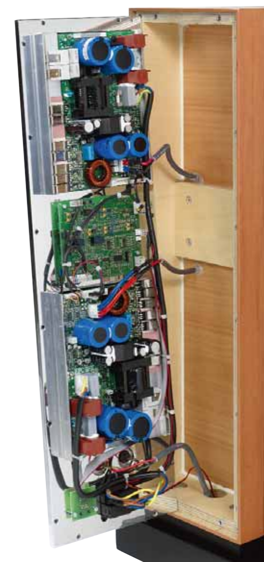
Die aktive Weiche zur Abtrennung der höheren Lagen und die effektiven Class D-Endstufen sitzen abgeschirmt von den Bässen in einer Kammer
