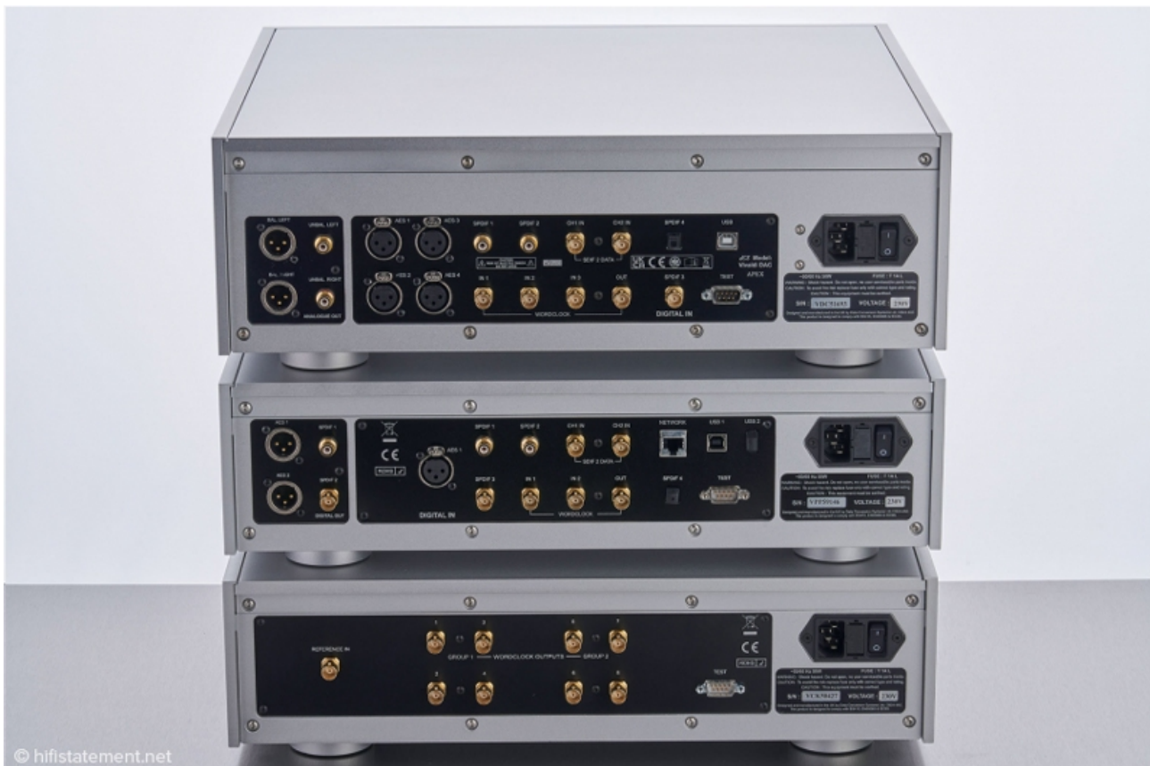
Jede Menge Ein- und Ausgänge: Für den Test wurden die Geräte untereinander mit vier von dCS beigepackten BNC-Kabeln für das Clock-Signal und 2 AES-Leitungen zum Signaltransport vom Upsampler zum DAC verbunden
