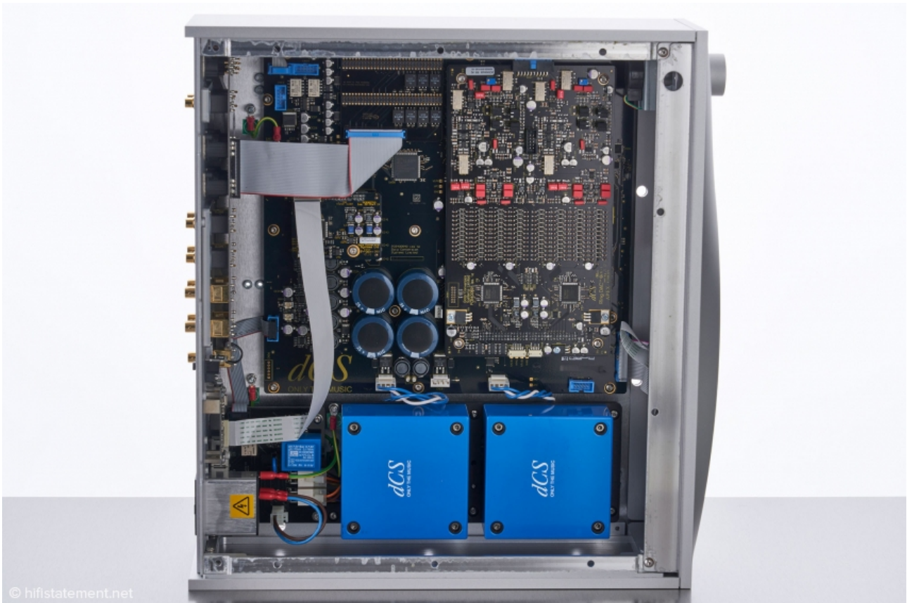
Im Vivaldi DAC beanspruchen die beiden gekapselten Netztrafos und der Ring DAC die meiste Fläche
