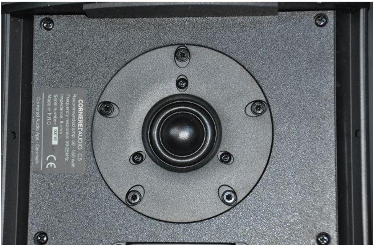
Obwohl an Details, wie dem vorne angebrachten Typschild, oder der sichtbaren Schallwandverschraubung sofort erkennbar wird, dass die C5 im Normalfall für eine Aufstellung mit Schutzgitter konzipiert sind, hat sich der Hersteller in Bezug auf die Chassiseinpassung dennoch Mühe gegeben. Der C5 liefert diesbezüglich ein tadelloses Niveau ab, bei dem auch kritische Anwender absolut zufriedengestellt werden.
