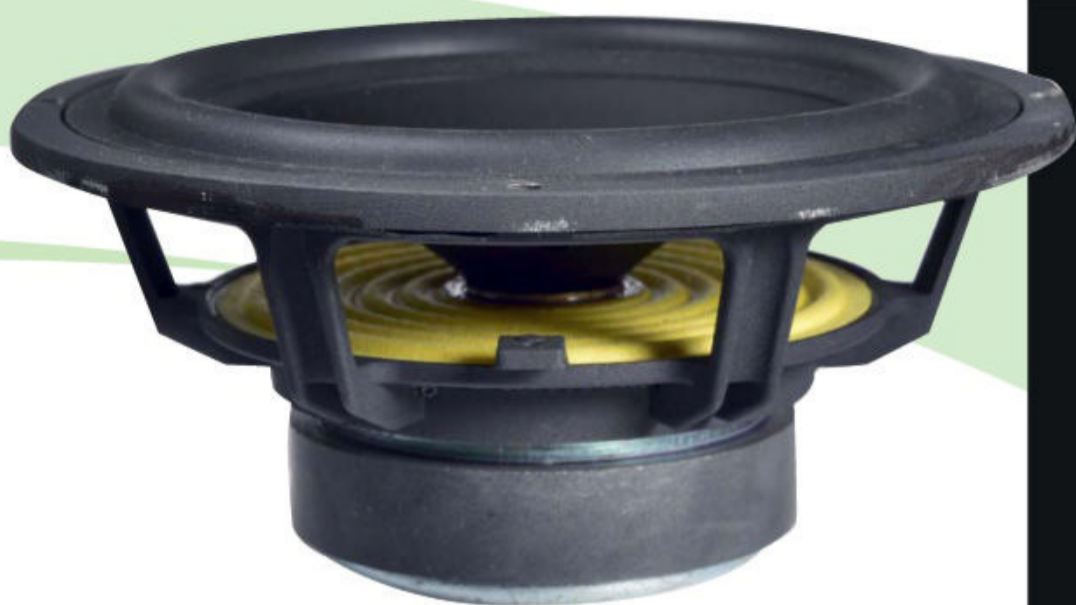
Das Bass- und das Tief-Mittelton-Chassis arbeiten beide mit hochstabilen, strömungs-optimierten Alu-Druckgusskörben. Die Sicken sind hinterlüftet.
